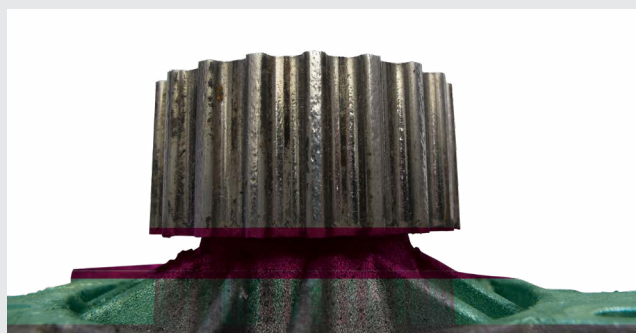
Roata de antrenare deteriorată din cauza murdăriei și uzurii (deteriorarea rulmenților)
