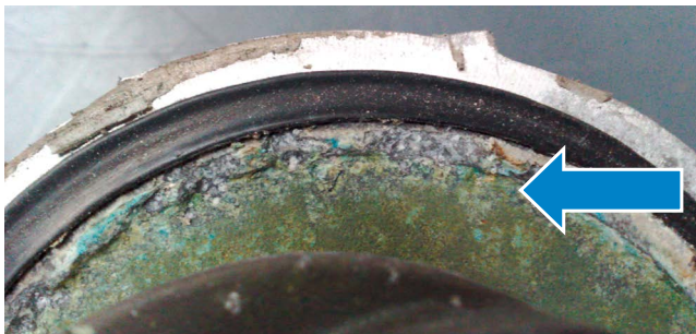
Lichidul de răcire necorespunzător a dus la coroziune și neetanșeități
