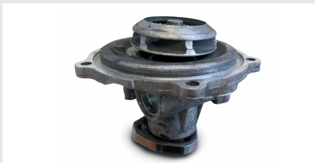
Deteriorarea rulmenților din cauza tensionării excesive a curelei
