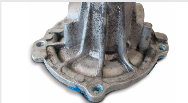
Deteriorarea rulmenților din cauza problemelor la cureaua (abraziune la cauciuc, particule pe carcasă)
